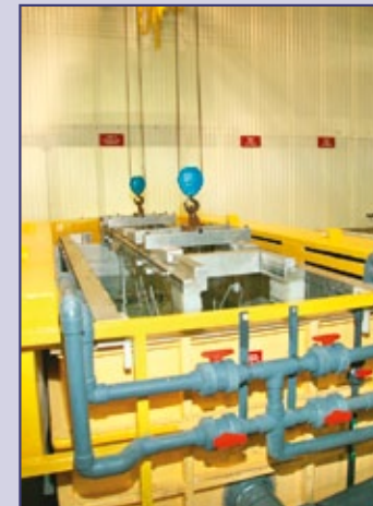
Produktionslinie für den Beschichtungsprozess mit Alodine®EC 2 .
