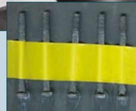
Aluminiumbeschichtete Stahlbolzen (13 Mikrometer Schichtdicke), 7 Mikrometer Alodine®EC 2 , 2.000 Stunden Salznebel (ASTM B-117), kein Rotrost an den Befestigungselementen
