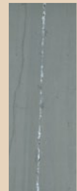
Nach 2.000 Stunden Salzsprühetest kein Rotrost auf aluminiumbeschichtetem Stahl.
